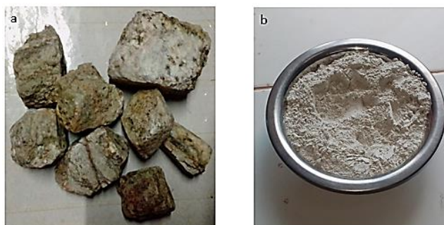
Fig. 2. a) Unground feldspar b) Ground feldspar
